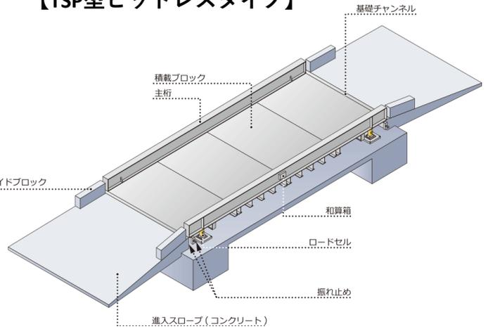
左右両端に設けたガードが透けた役割をするため、深いピットが要らないタイプ。スケールの前後にスロープを設けて、トラックの乗り入れを行います。
