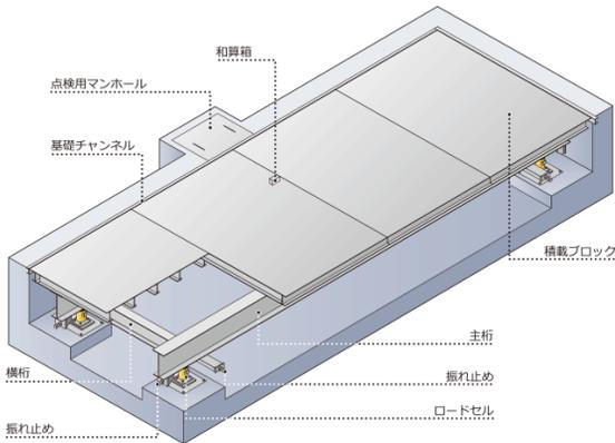
主桁・荷重検出部共に地中のピット内にあり、積載面上と地上が同レベルとなるタイプ。スロープなどが不要で設置スペースが少なくてすみます。
