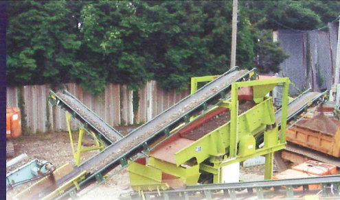
2段式仕様(オプション)による、 破碎後の廃コンクリート3種選別設備
