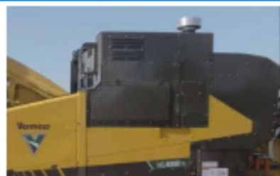
CAT C13B Tier4F 400kW 540PSのエンジンを搭載し、高い生産性を誇ります。
