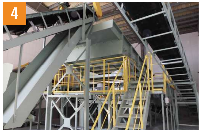
切削チップを旋回スクリーンにより効率的に篩分します。 HRS-2470
